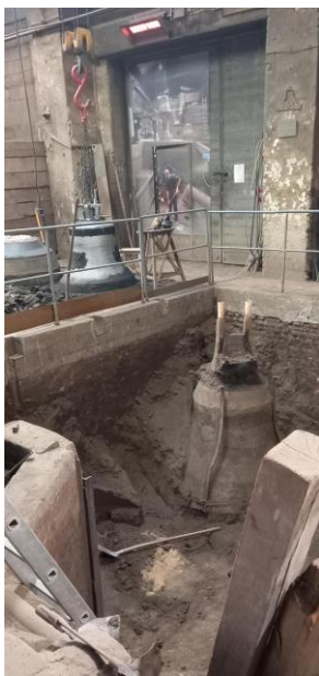
Die Gussgrube ist den großen Glocken mit einem Gewicht von bis zu 5 Tonnen vorbehalten. Hier werden die Gussformen in der Grube vollständig mit Sand eingefasst. Im Hintergrund ist eine Glocke zu sehen, die in der Vorwoche gegossen wurde und nun aus ihrer Gussform befreit wurde. Die spätere Farbe unserer Glocke lässt sich hier erahnen.
