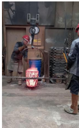
Wegen der großen Hitze und der Gefahr, die von Metallspritzern ausgeht, müssen die drei Glockengießer Schutzbekleidung tragen. Nach dem wochenlangen Arbeiten an der Gussform und dem stundenlangen Schmelzen des Metalls dauert das eigentliche Gießen nur wenige Minuten. Anschließend kühlt die Glocke etwa eine Woche aus, bevor die nächsten Arbeitsschritte folgen.
